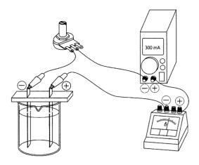
図 3: 硫酸銅水溶液の電気分解装置
